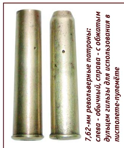
*7,62-мм револьверные патроны: слева - обычный, справа - с обжатым дульцем гильзы для использования в pistolете-пулемёте*
