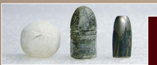
купорки, даже при наличии специальных поперечных канавок на поверхности пуль, смазка с них быстро стиралась, что приводило при стрельбе к ускоренному освинцовыванию канала ствола оружия. Такая конструкция до сегодняшнего дня используется в малокалиберных патронах бокового боя.
