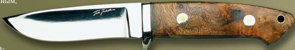
*или даже может нанести серьёзную рану как владельцу ножа, так и окружающим его людям.* Угол острия 40-50° вполне достаточен для того, чтобы придать охотничьему ножу колющие свойства и тем самым придать ему некоторые признаки оружия. Оружия вспомогательного, рассчитанного на добивание тяжело раненного зверя, что, как это подтвер-
