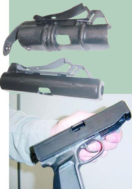
вперёд, выступы воздействуют на предохранитель и затвор, при обратном движении затвор досыпает патрон в патронник. Таким образом, из кобуры пистолет извлекается уже готовым к открытию огня.
