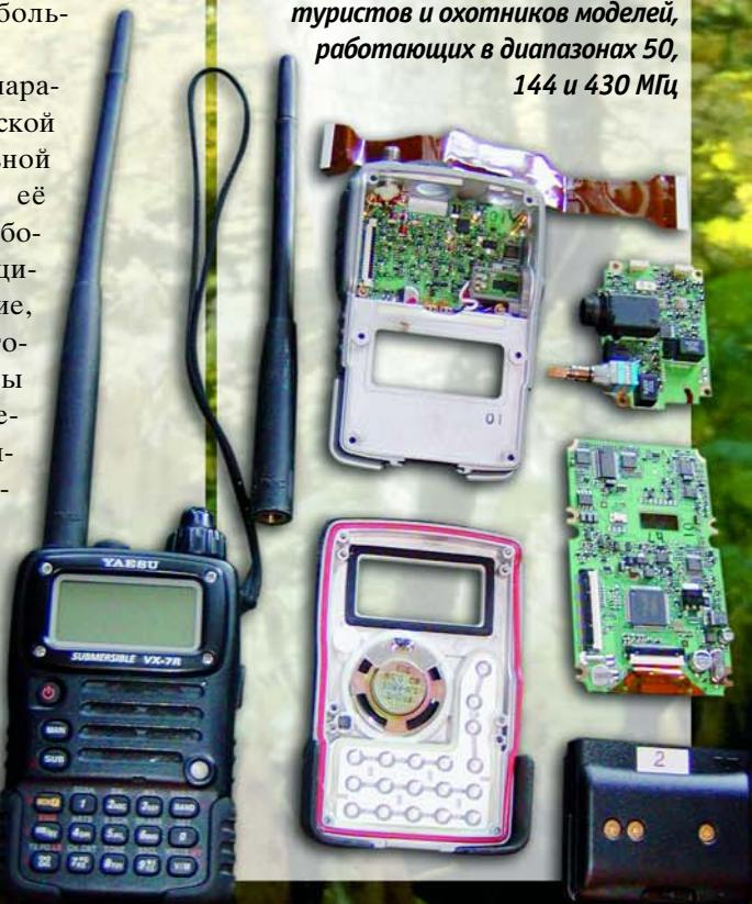
ланы в соответствии с западным военным стандартом MIL 810, что говорит об их надёжности, а некоторые, например, Yaesu VX-7r, имеют даже защиту от воды по стандарту JIS7, т.е. сохраняют работоспособность после погружения в воду на глубину 1м на 30 минут. Yaesu VX-7r заслужила большую популярность у туристов, её часто применяют парапланеристы, что свидетельствует о надёжности. Она стоит того, чтобы о ней рассказать подробнее.
