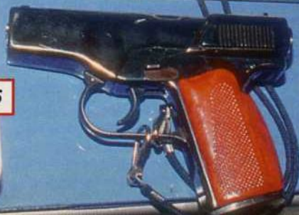
Пистолет-пулемет "Ступа" Разработчик: КБ Калибр: 7,62 мм ПМ Емкость магазина: 35 патронов Вид огня: один / автомат.
