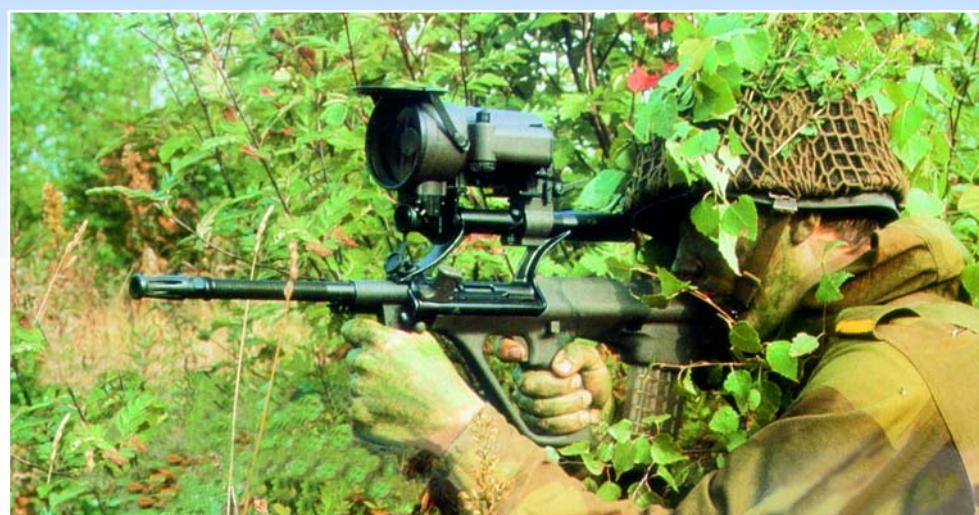
Однако недостатки данного технического решения очевидны: увеличение веса и габаритов, нарушение балансировки оружия и т.д. Снятие и установка ночной приставки требует определённого времени и вносит некоторую ошибку между ночным и дневным каналами.
