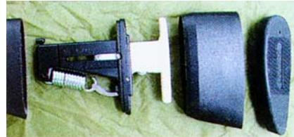
**Компания Knoxx** вышла на рынок с оригинальной системой компенсации отдачи. Пружинный механизм устанавливается в приклад. Изюминка системы в том, что пружина при выстреле посредством эксцентрика работает на растяжение, а не на сжатие, что в значительной мере смягчает субъ-
