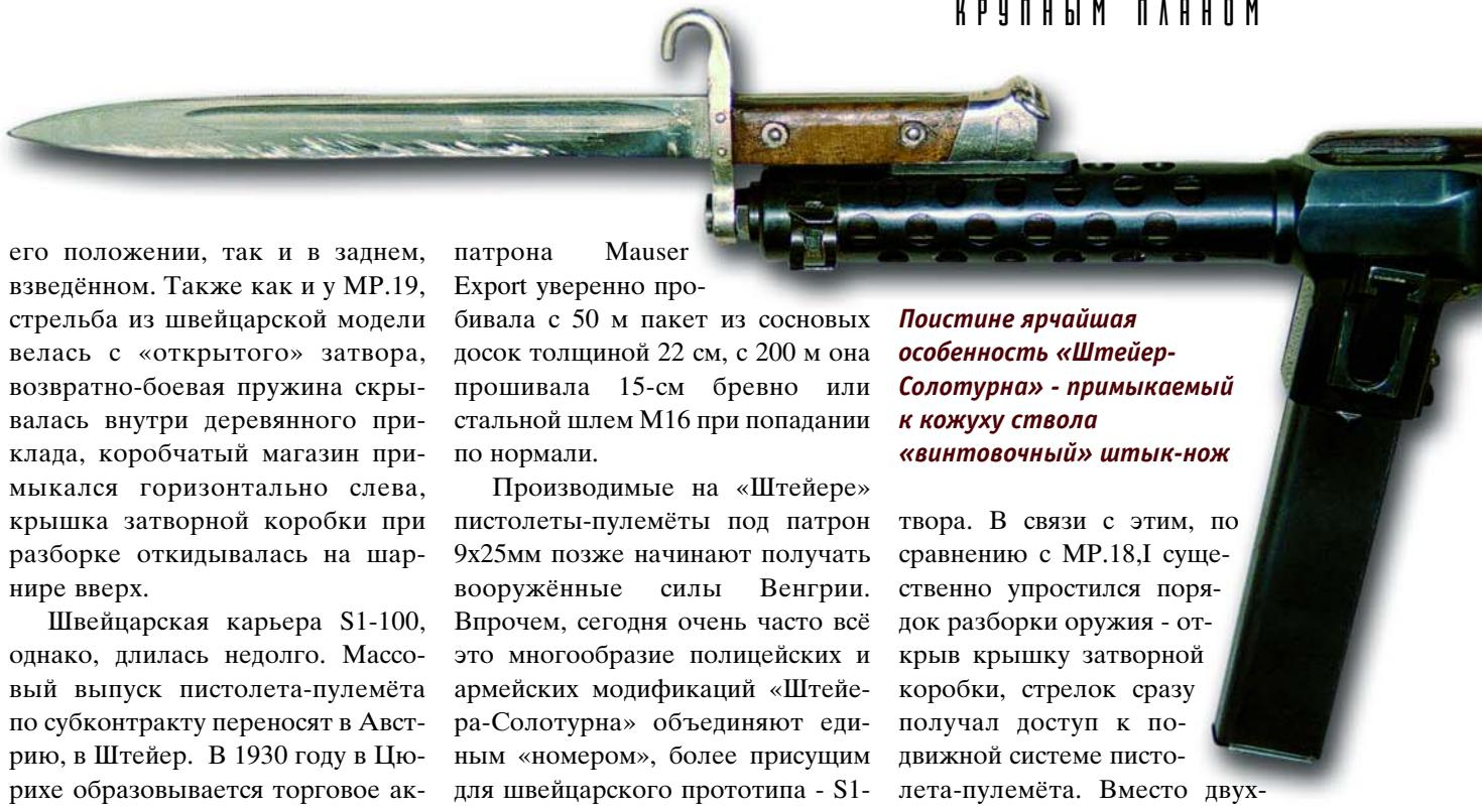
его положении, так и в заднем, взвешенном. Также как и у MP.19, стрельба из швейцарской модели велась с «открытого» затвора, возвратно-боевая пружина скрывалась внутри деревянного приклада, коробчатый магазин прикался горизонтально слева, крышка затворной коробки при разборке откидывалась на шарнире вверх.
