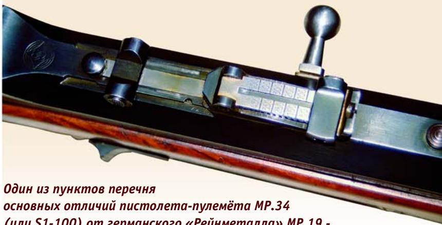
*Один из пунктов перечня основных отличий пистолета-пулемёта MP.34 (или S1-100) от германского «Рейнметалла» MP.19 - оригинальная конструкция предохранителя, выполненного в виде подпружиненной пластины с передвижным хомутиком*
