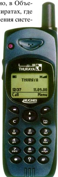
лее сигаретной пачки - весят 220 граммов, 14x5x2,5 см) и по функциям: возможности работать в спутниковом и сотовом режимах, возможности передавать данные и факсы на низкой скорости в 9,6 кбит/сек. Приятная неожиданность - оба аппарата являются сильно упрощенными приемниками GPS.
