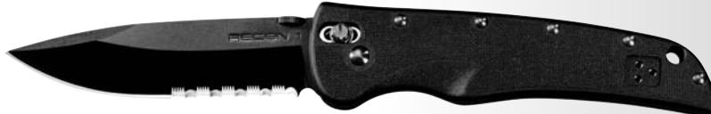
**Фото 6.** Складной нож 27LSH Recon 1 Spear Point фирмы Cold Steel (США). Клинок выполнен из японской стали AUS 8A с тefлоновым (Teflon) чёрным покрытием, рукоять из Zytel. Для фиксации клинка применён оригинальный замок Ultra Lock, разработанный фирмой. На части лезвия клинка выполнена серрейторная заточка с переменным шагом.
