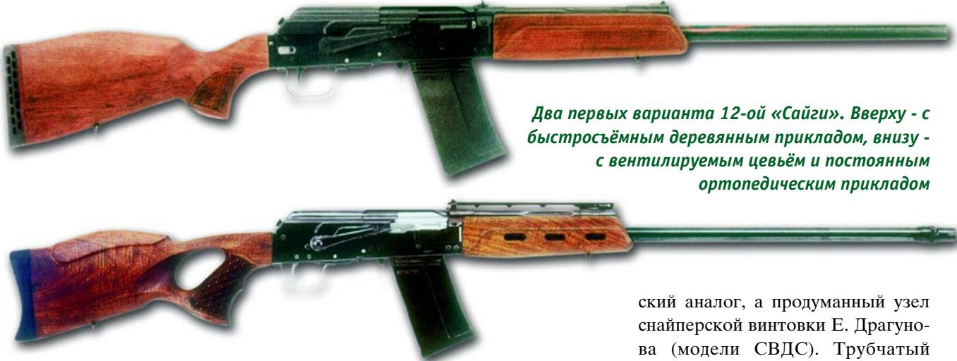
*Два первых варианта 12-ой «Сайги». Вверху - с быстросъёмным деревянным прикладом, внизу - с вентилируемым цевьём и постоянным ортопедическим прикладом*
