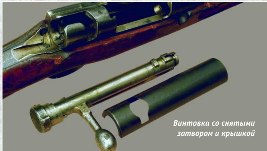
**Винтовка со снятыми затвором и крышкой**
