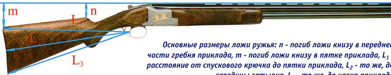
**Основные размеры ложи ружья: n - погиб ложи книзу в передней части гребня приклада, m - погиб ложи книзу в пятке приклада, L<sub>1</sub> - расстояние от спускового крючка до пятки приклада, L<sub>2</sub> - то же, до середины затылка, L<sub>3</sub> - то же, до носка приклада**
