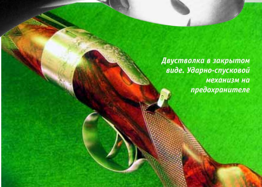
*Двустволка в закрытом виде. Ударно-спусковой механизм на предохранителе*
