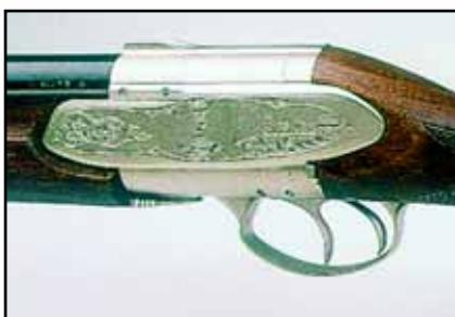
В этом ружье осуществлён тот же принцип запирания, что и в «Малышке», то есть попреречным болтом на два стальных стержня. Однако эти стержни гораздо короче и при отводе стволов вперёд выходят из соответствующих гнёзд колодки. В крайнем переднем положении стволы с небольшим усилием опускаются вниз. Ружьё готово для удобного заряжания и удаления стрелянных гильз.
