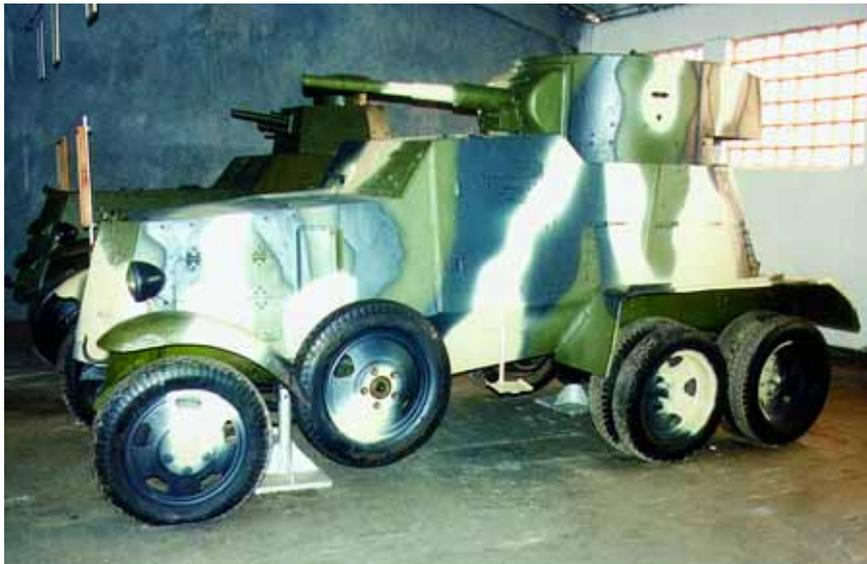
**Бронеавтомобиль БА-3. В июне 1934 года проходил испытания на Кубинском полигоне. Башня от танка Т-26 с 45-мм пушкой**
