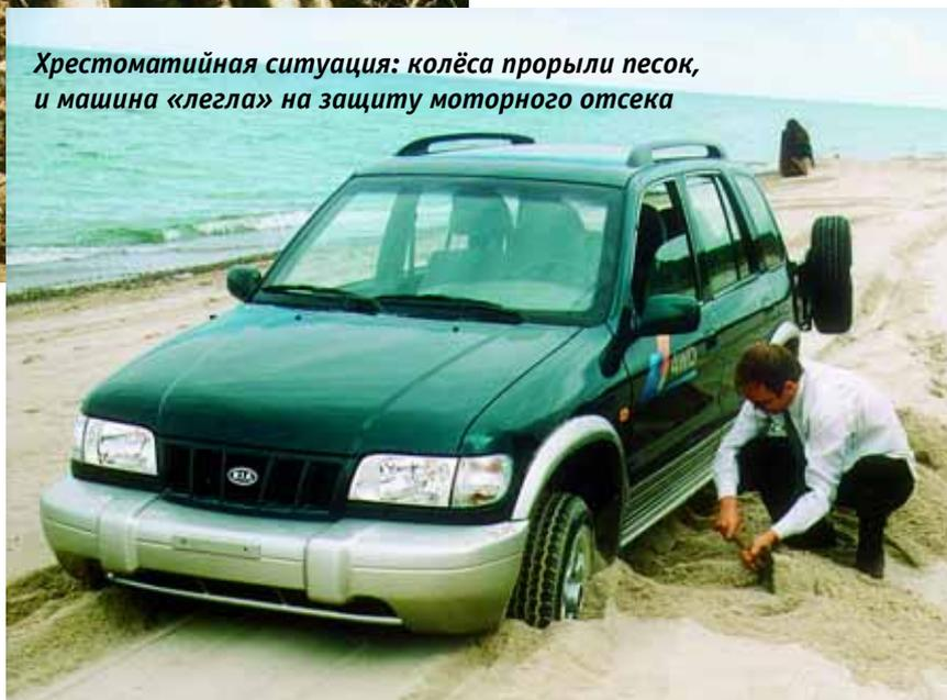
*Хрестоматийная ситуация: колёса прорыли песок, и машина «легла» на защиту моторного отсека*
