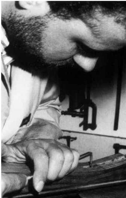
**Дидье Тис начинает работу с врезки коробки в грубую ложевенную заготовку**
