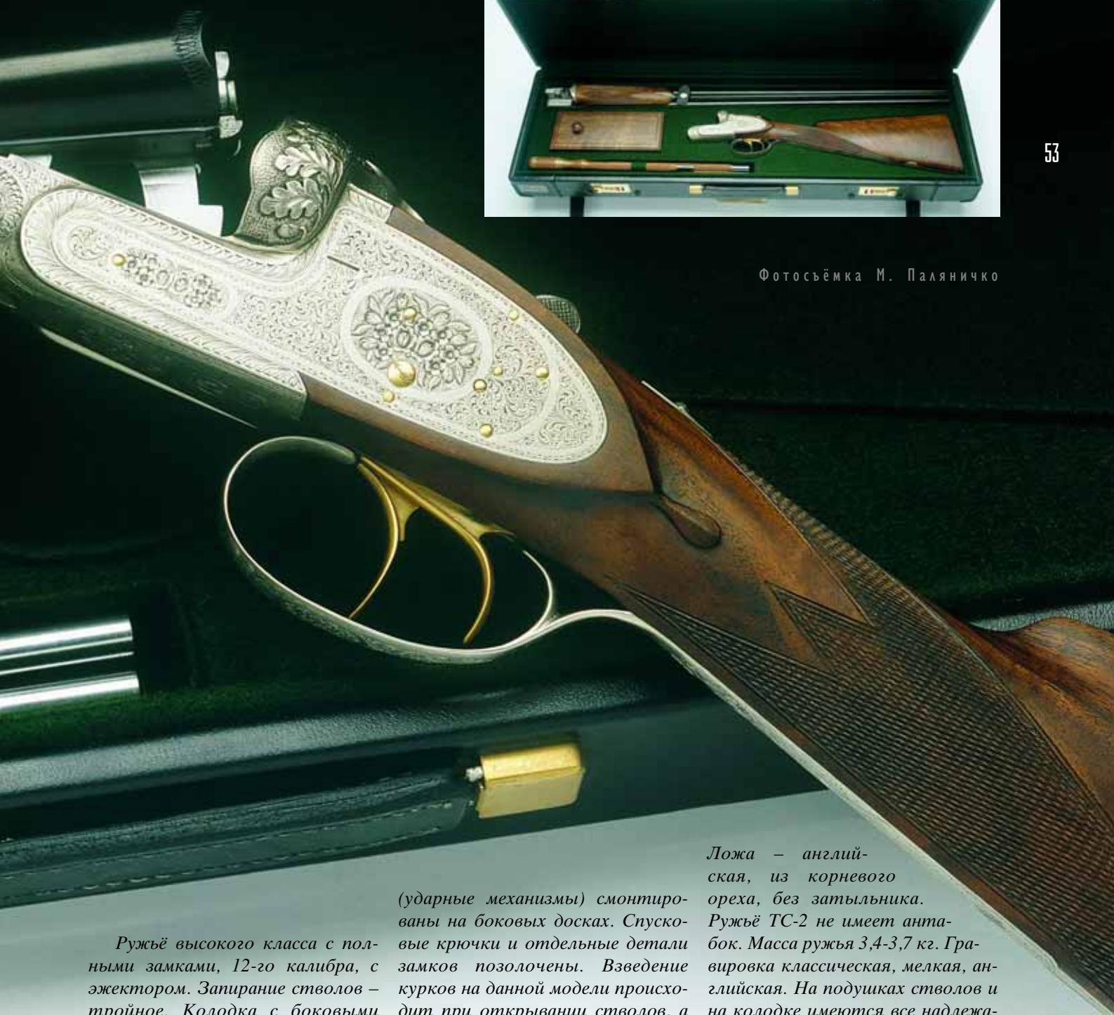
Ружьё высокого класса с полными замками, 12-го калибра, с эжектором. Запирание стволов – тройное. Колодка с боковыми приливами от расшатывания стволов. Данная модель предназначалась для стрельбы на траншейном стенде и спортивной охоты. Кучность боя обоих стволов 75-80%. Длина стволов 760 мм. Дульные сужения 1,25-1 мм. Патронник 70 мм. Ствольная сталь марки 50А. Прицельная планка высокая, гильошированная. Замки
