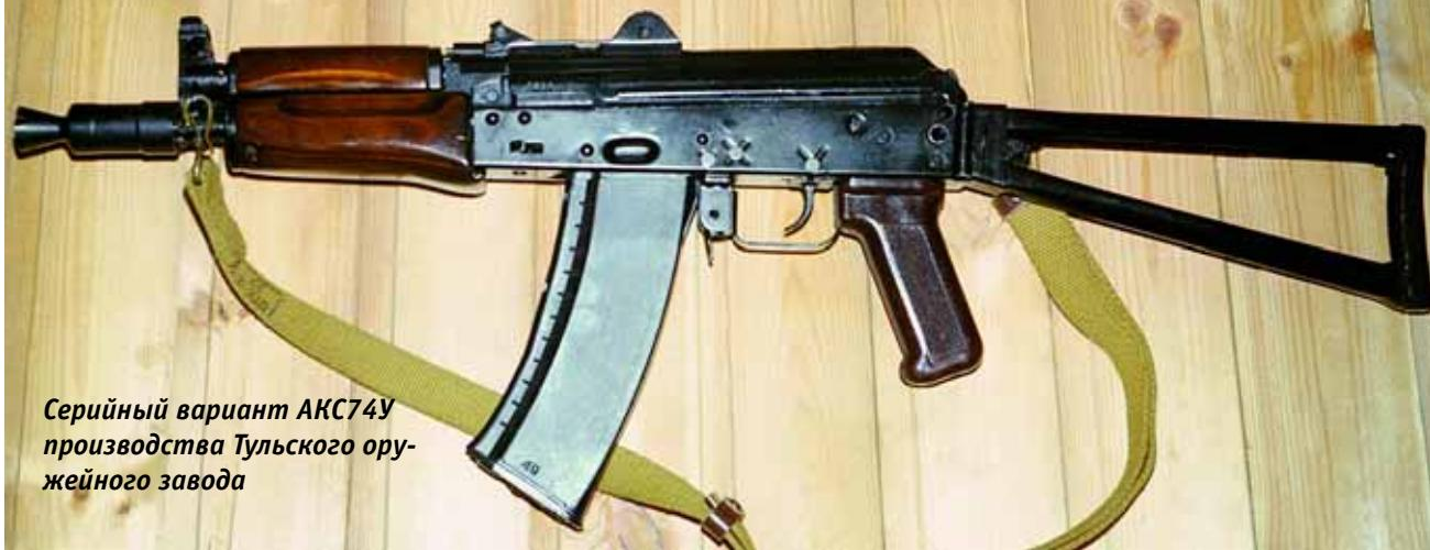
ный 5,45-мм автомат пришлось сравнивать с мощным 7,62-мм АКМС. Окончательный вариант малогабаритного автомата системы Калашникова максимально унифицировали с уже принятым к тому времени на вооружение АКС74...
