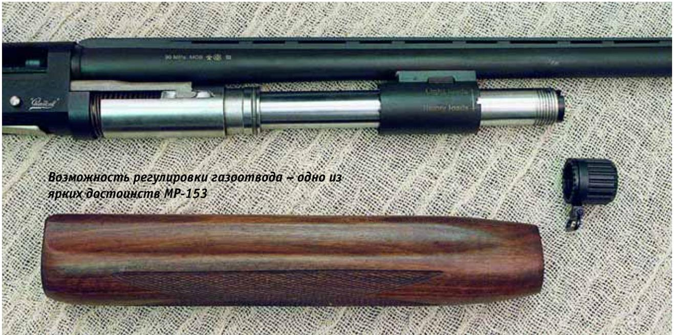
*Возможность регулировки газоотвода – одно из ярких достоинств МР-153*
