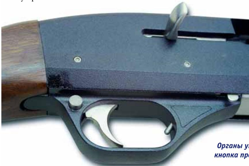
*Органы управления ружья (рукоятка затвора, кнопка предохранителя, флажок затворной задержки) рассчитаны на правшу*
