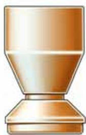
**Пуля Рубейкина представляет собой слегка изменённый вариант пули Блондо. Стабилизация в полёте обеспечивается за счёт ударного аэродинамического эффекта. Материал - латунь, сталь, медь.**
