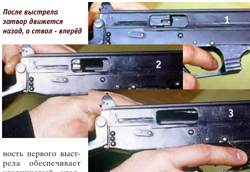
ность первого выстрела обеспечивает ударниковый ударно-спусковой механизм.
