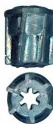
**Пуля Майера - дважды турбинная. Наружные лопасти выполняют роль ведущих поясков, центрируя пулю в канале ствола. Продольный внутренний канал имеет наклонные рёбра, в головной части сходящие на нет, и наиболее высокие - у основания пули.**
