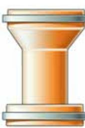
**Стальная или медная пуля Ролана Блондо конструктивно напоминает катушку для ниток. На цилиндрических поверхностях имеются кольцевые проточки типа «ласточкин хвост» для запрессовки свинцовых поясков.**
