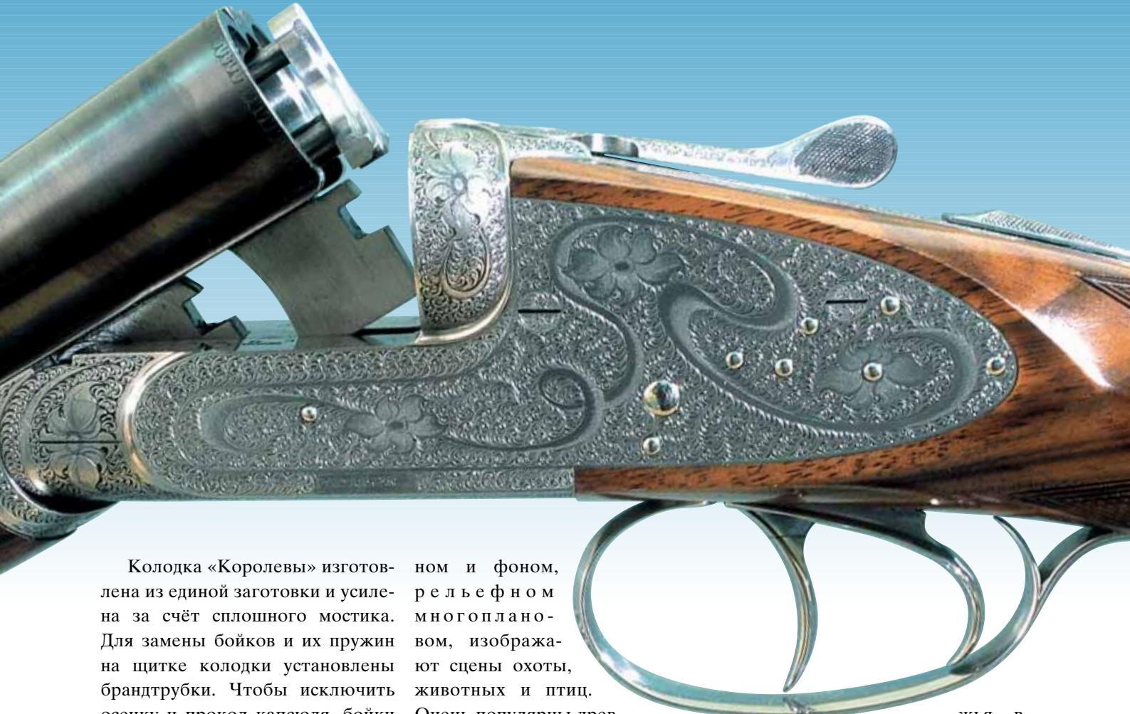
Колодка «Королевы» изготовлена из единой заготовки и усиlena за счёт сплошного мостика. Для замены бойков и их пружин на щитке колодки установлены брандтрубки. Чтобы исключить осечку и прокол капсюля, бойки выполнены сравнительно большого диаметра 2,4 мм, а их наконечники закруглены в виде полусферы.
