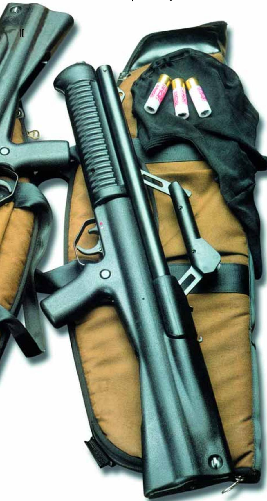
**Оправдавшая** себя в нарезном автоматическом оружии конструкция типа буллпап нашла своё применение и при создании гладкоствольного ружья. Конструктор Хайнц Стид (Heinz Stead) в сотрудничестве с южно-африканской фирмой Truelo Manufacturers Ltd. Armory Division создал необычное помповое ружьё под названием Neostead.
