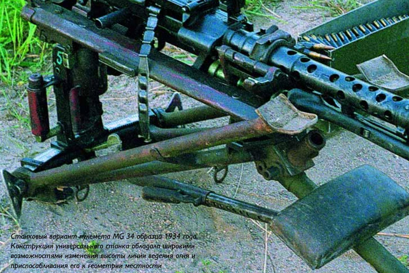
Станковый вариант пулемёта MG 34 образца 1934 года.
