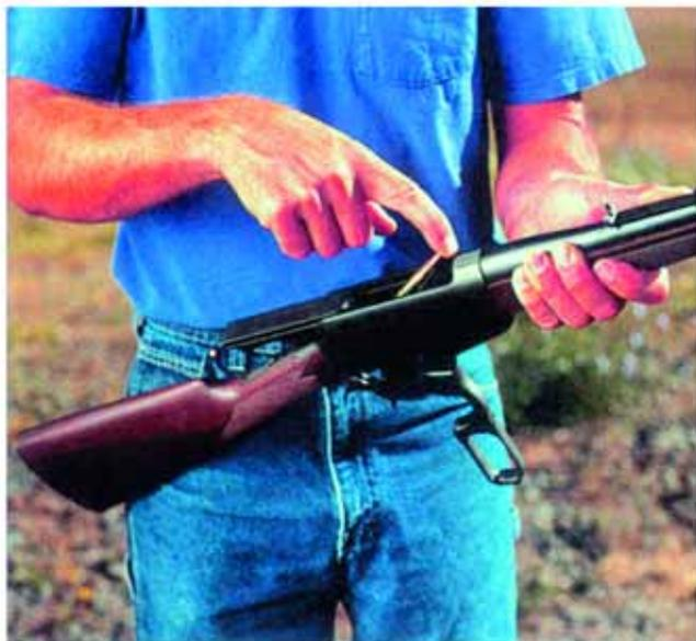
Патроны вставляются в магазинную коробку сначала донцем вниз в направляющие подающего механизма, затем укладываются горизонтально
