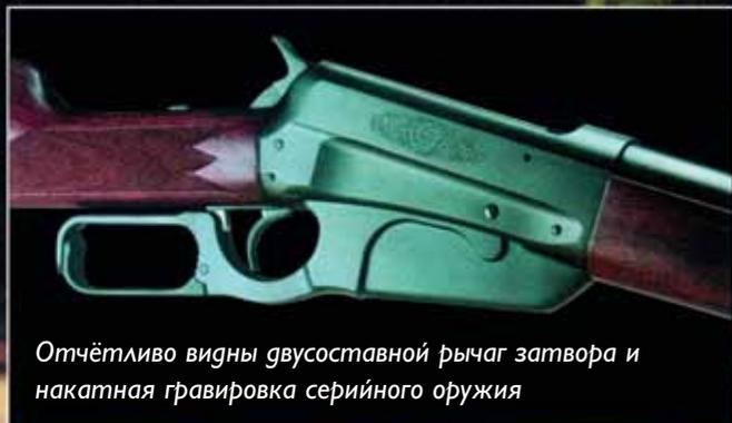
*Отчётливо видны двусоставной рычаг затвора и накатная гравировка серийного оружия*
