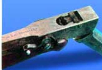
*После переламывания ствола становится виден капсюль. Справа - рычаг предохранителя*
