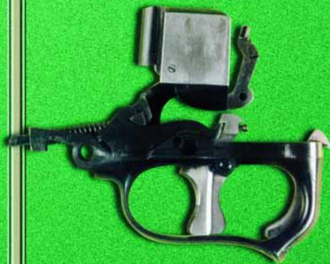
Взведённый ударно-спусковой механизм с затвором в верхнем (запертом) положении
