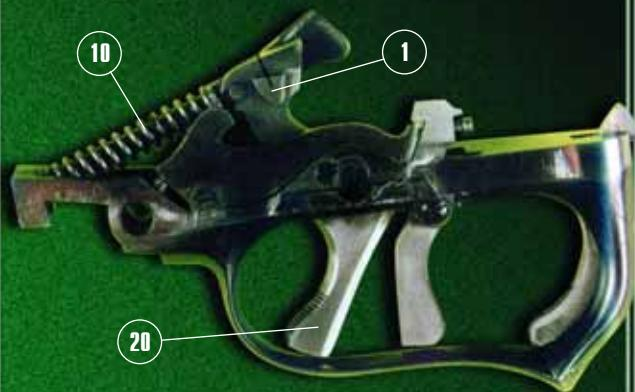
Ударно-спусковой механизм со спущенным курком (1), на который давит боевая пружина (10). Рычаг курка (20) - в крайнем заднем положении
