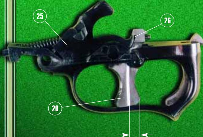
Ударно-спусковой механизм взведён. Рычаг курка (20) в крайнем переднем положении. Курок удерживается в заднем положении задней частью передаточного рычага (тяги) (25), в то время как спусковой крючок своим боевым вырезом удерживает переднюю часть курка
