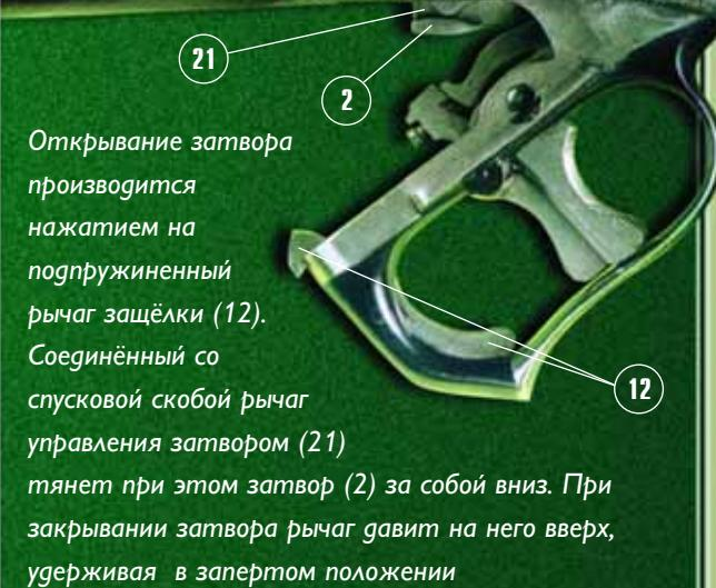
Открывание затвора производится нажатием на подпружиненный рычаг защёлки (21). Соединённый со спусковой скобой рычаг управление затвором (21) тянет при этом затвор (2) за собой вниз. При закрывании затвора рычаг давит на него вверх, удерживая в запертом положении
