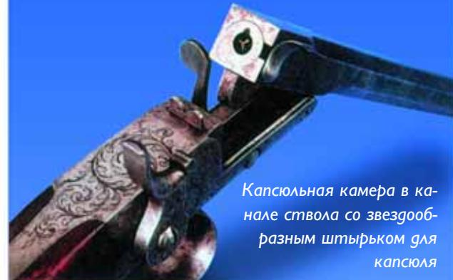
Капсюльная камера в канале ствола со звездообразным штырьком для капсюля
