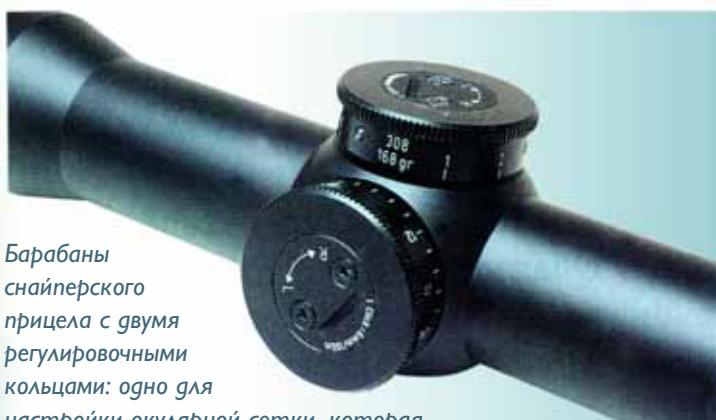
Барабаны снайперского прицела с двумя регулировочными кольцами: одно для настройки окулярной сетки, которая осуществляется один раз при установке прицела, другое для компенсирования понижения траектории пули или бокового сноса, которым пользуются постоянно
