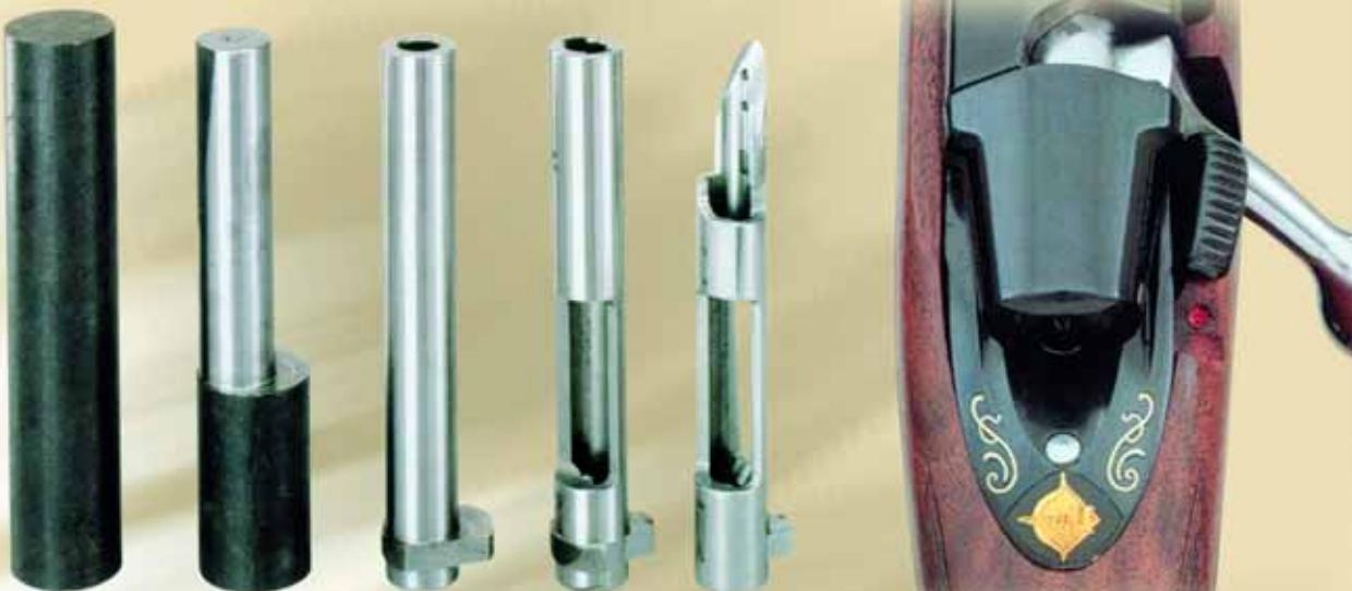
*Направляющий цилиндр затворной коробки вытаскивается из прутка конструкционной стали*
