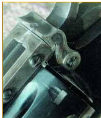
**Защёлка ствола (сверху - расположенная на стволе у первых моделей, снизу - с фиксатором на рамке, предложенная майором Скофилдом)**
