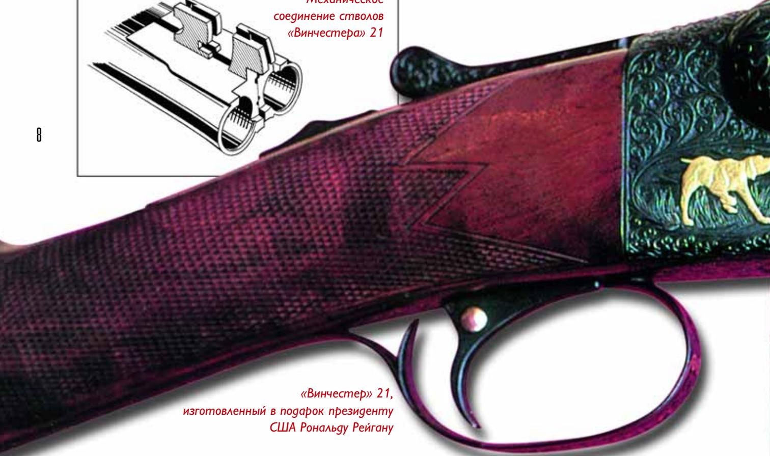
при соединении стволов не спаиваются, как обычно, а соединяются механически (см. рисунок) по принципу «ласточкина хвоста», или «chopper lump».
