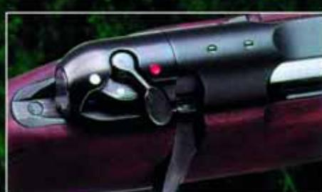
В тыльной части затвора с правой стороны смонтирован трёхпозиционный предохранитель
