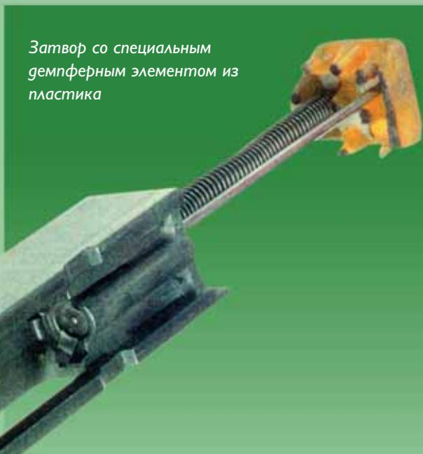
Затвор со специальным демпферным элементом из пластика
