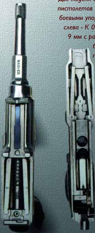
*Две модели самозарядных пистолетов с запиранием боевыми упорами: оружие слева - К 06/08 калибра 9 мм с расположением боевых упоров позади затвора (ранняя конструкция), справа - К 12/14 с кольтовским патроном .45-го калибра и передним расположением боевых упоров*
