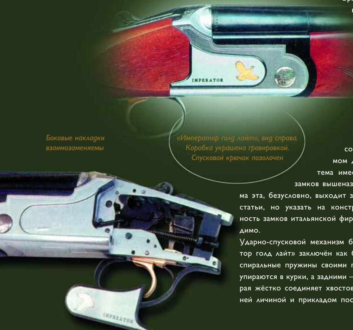
болта. В Европе рамочная система замков применяется в 70% выпускаемых бокфлнтов, разумеется, с теми или иными конструктивными вариациями. Спусковой механизм «Императора голд лайт» имеет унитарный спусковой крючок и переключатель последовательности выстрелов, совмещённый с кнопкой предохранителя.
