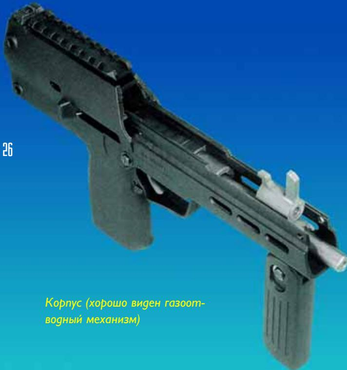
*Корпус (хорошо виден газоотводный механизм)*
