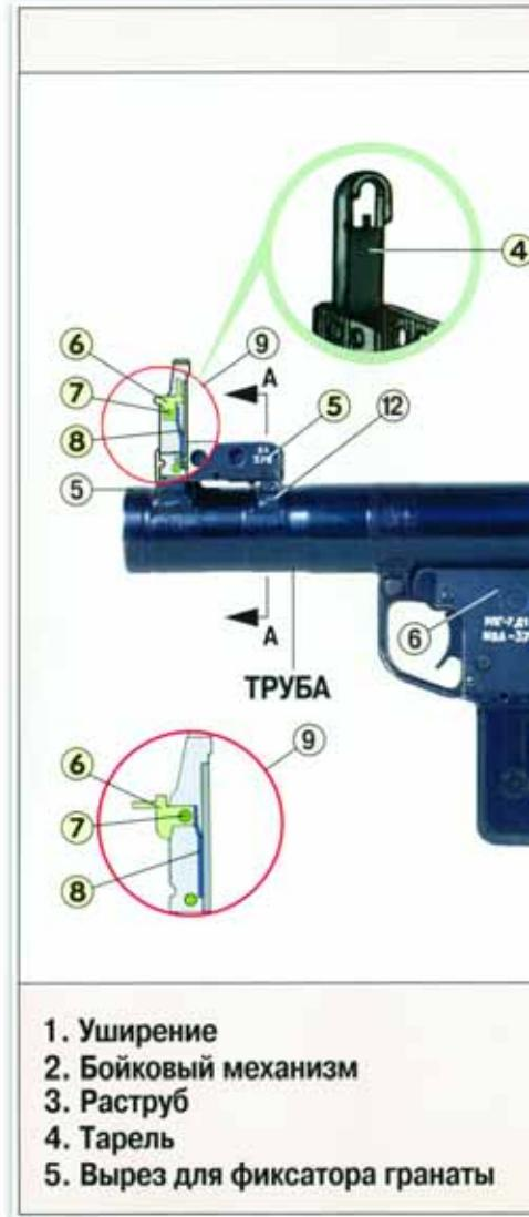
Ударно-спусковой механизм служит для постановки гранатомёта на боевой взвод, спуска курка с боевого взвода и нанесения удара по бойку.
