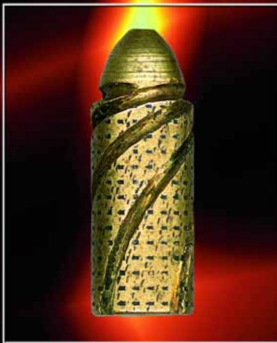
Единственный в мире осуществлённый и реально действующий проект газотурбинной пули инженера Богомолова. Кучность боя малых калибров не отличается от винтовочной, при этом применяется быстрогорящий охотничий порох «Сокол». Газы, вытекающие из канавок с прогрессирующим углом наклона, снижают максимальное давление в канале ствола
