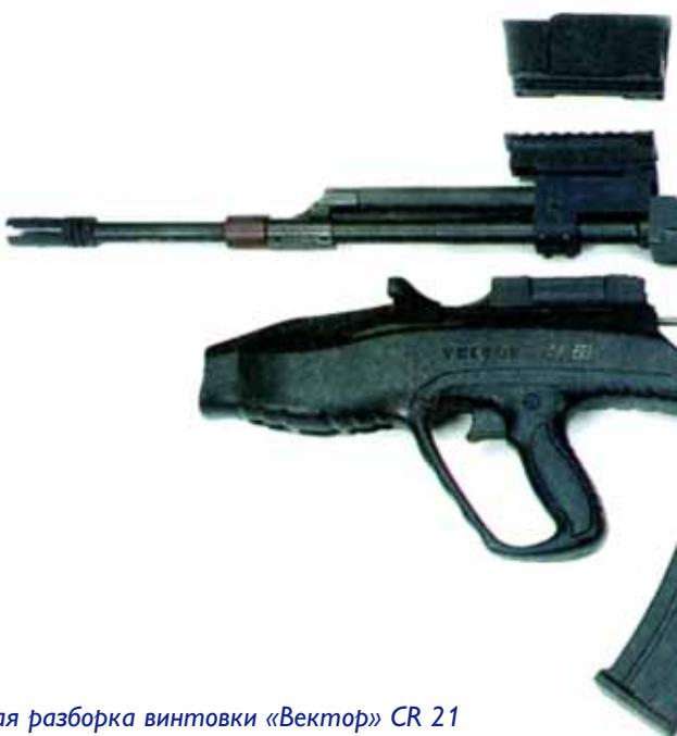
Неполная разборка винтовки «Вектор» CR 21
