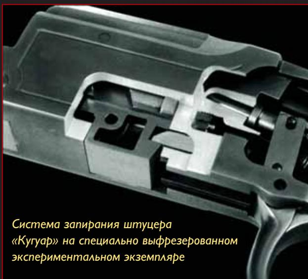
Система запирания штуцера «Кугуар» на специально выфрезерованном экспериментальном экземпляре
