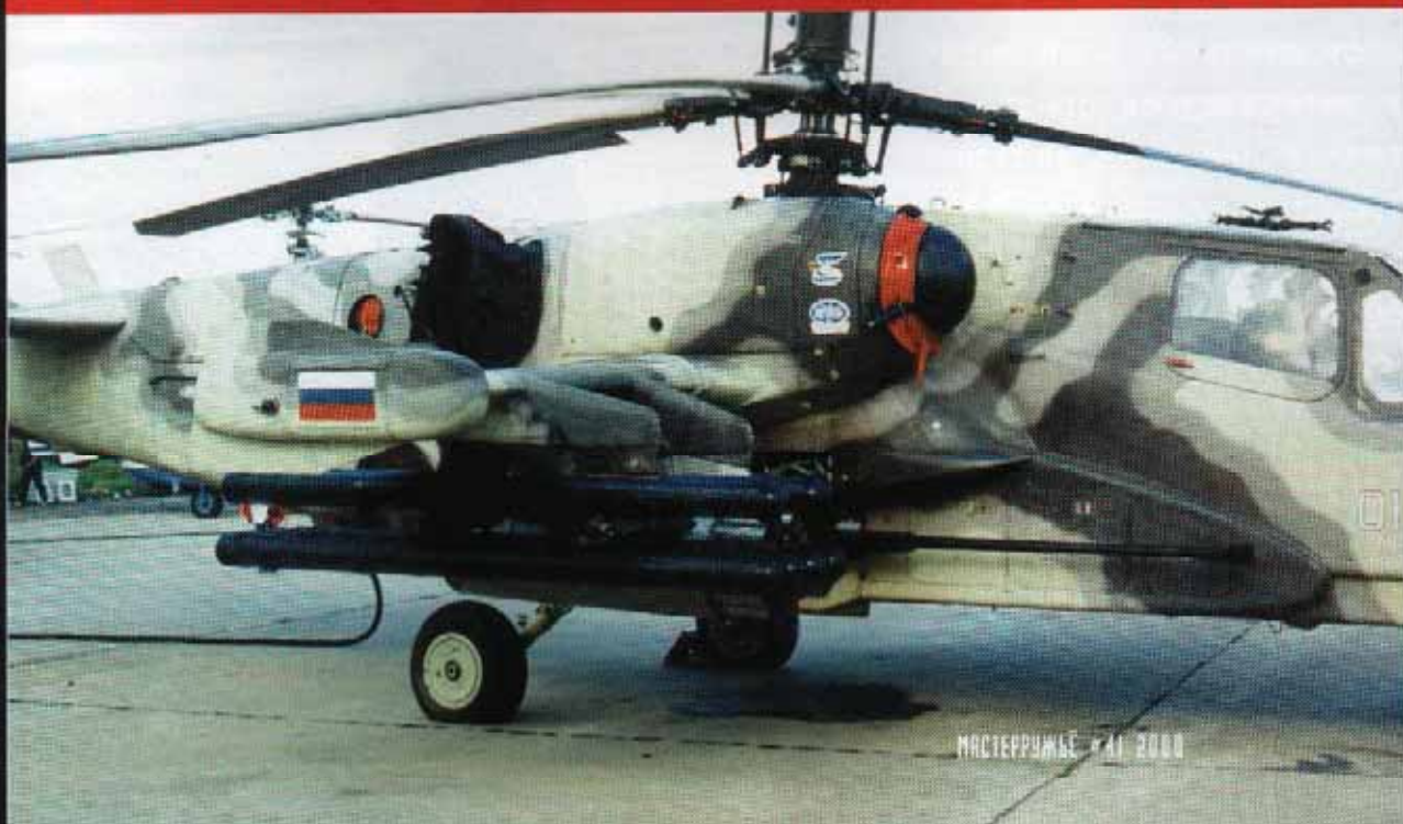
Пилон с вооружением вертолёта Ка-50: на первом плане – блок из шести управляемых ракет, за ним блок Б20В для неуправляемых авиационных ракет С-8, на фюзеляже – подвижная установка под пушку 2А42
