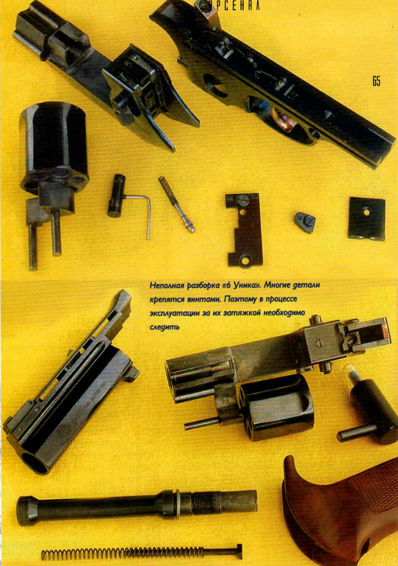
Диаметр камеры барабана таков, что зазор между пулей .357 и стенками составляет 0,3 мм, это существенно снижает скорость пули
