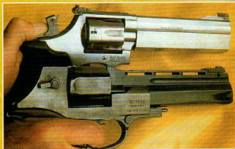
На фото отчетливо видно, насколько меньше плечо отдачи у «6 Уника», чем у знаменитого «Смит энд Вессона» .357 «магнум»
