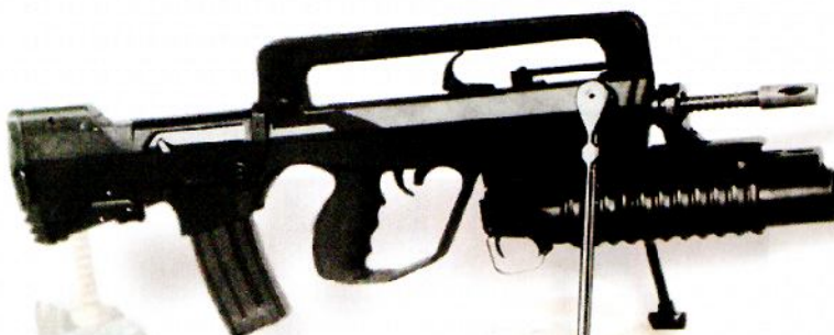
Новейшая модификация автомата ФАМАС Ж2 (FAMAS G2) с подствольным гранатомётом калибра 40 мм
