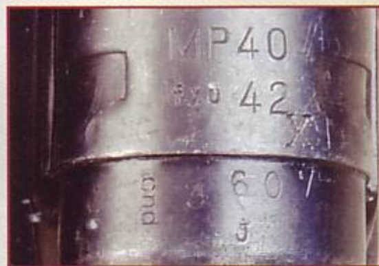
Фрагмент пистолета-пулемёта MP 38 (вверху), изготовленного фирмой «Эрма» (код 27) в 1940 году в г. Эрфурт. Фрагмент пистолета-пулемёта MP 40 (внизу), изготовленный фирмой C.G.Haenel, Waffen-und Fahrradfabrik в г. Зуле (код fxo) в 1942 году
