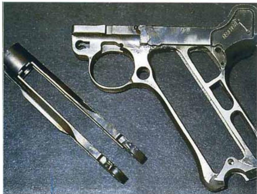
Корпус и подвижный механизм увеличенных размеров, готовые к сборке. Хорошо видны точки сварки деталей, принадлежащих двум разным «Люгерам»
