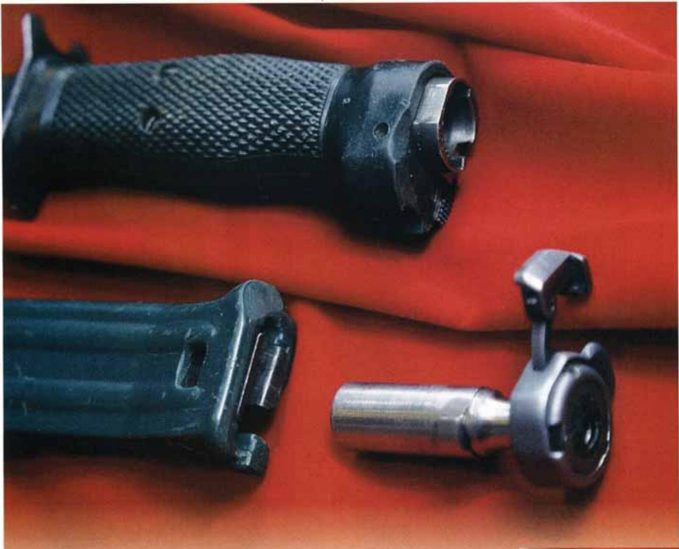
ких ножей похожа на конструкцию безрасходных пневматических подводных ружей. Такой нож может выстреливать или сам клинок, или специальный убойный элемент, вылетающий из рукоятки. В этом случае основной клинок остаётся на месте и может быть выполнен более массивным или многофункциональным. В качестве рабочего тела можно использовать и энергию сжатого газа. Например, встроить в рукоятку обычный баллончик сифонного типа, наполненный углекислым газом.
