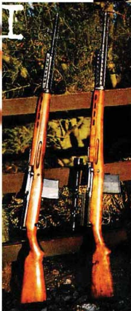
1. Две обычные винтовки Токарева (на правой винтовке установлен четырёхкратный оптический прицел «Бушнелль»)
