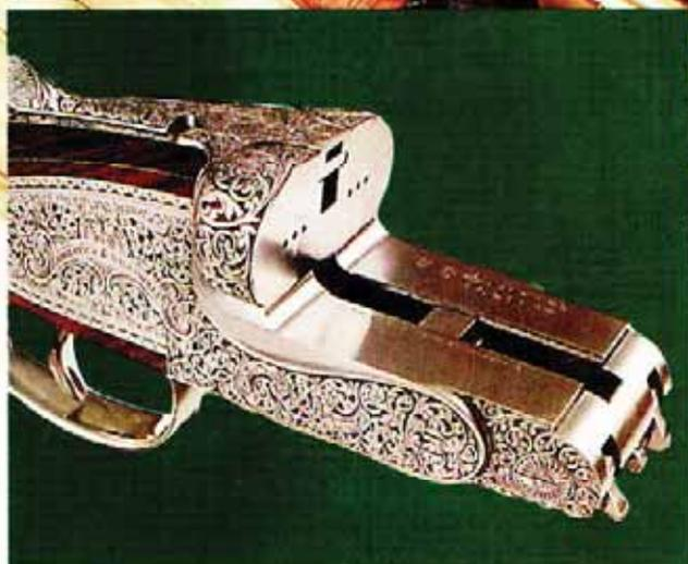
спянные в блок стволы изготавливаются из высококачественной бёлеровской стали (Bohler-Rasant-Chrom-Stahl) или из стали «Суперблиц». Боковые заклики легко вынимаются без инструмента. Кнопочный предохранитель-указатель ввода расположен на удлинённом хвостовике коробки, значительно усиливающим ложу. Система запирания – на два под-
