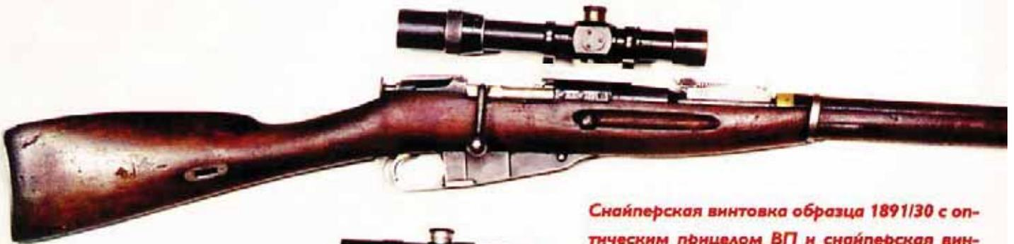
*Снайперская винтовка образца 1891/30 с оптическим прицелом ВП и снайперская винтовка СВТ-40 с оптическим прицелом ПУ*
