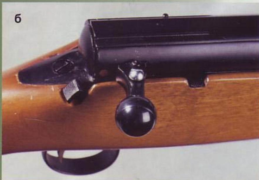
б) рукоятка затвора откинута (рабочее положение) предохранитель выключен
