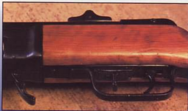
Переводчик огня в положении «автоматический огонь», рычаг защелки магазина откинут
