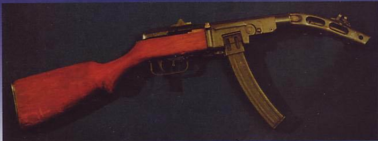
Опытный пистолет-пулемет Шпагина с искривленным каналом ствола. Модель 1945 г.
