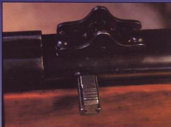
Прицел с перекидным целиком пистолета-пулемета Шпагина модели 1942 г.
