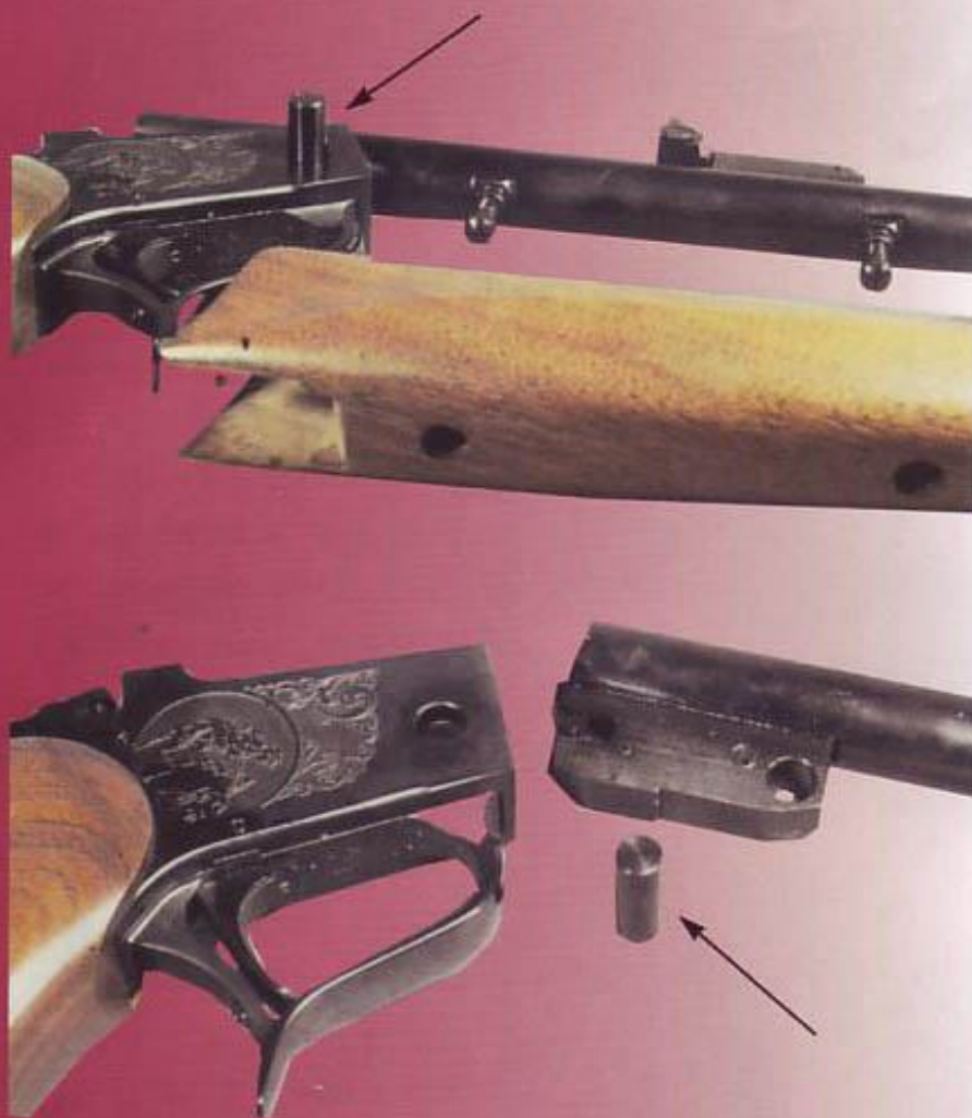
Замена ствола (стрелками показан фиксатор ствола)
