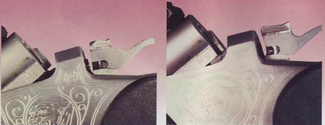
Пара бойков, расположенных вертикально в затворной коробке
