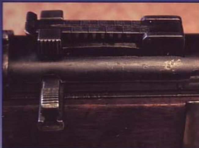
Секторный прицел пистолета-пулемета Шпагина модели 1941 г.
