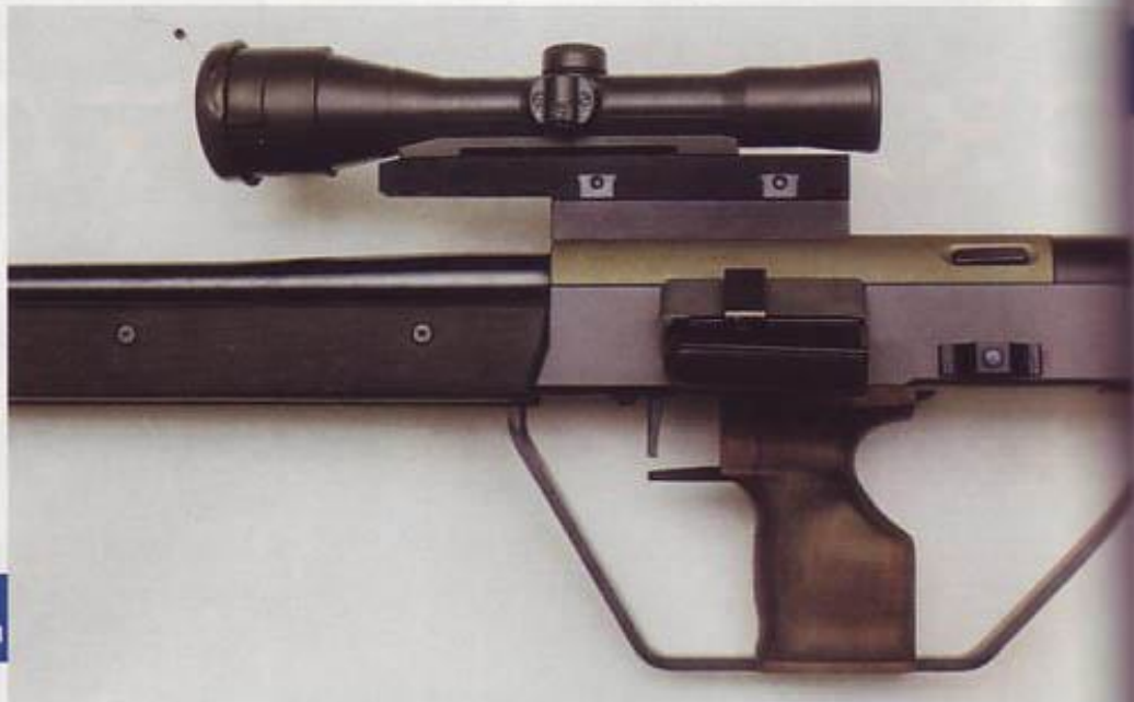
Слева: левая сторона винтовки Кепелера с выступающим магазином
