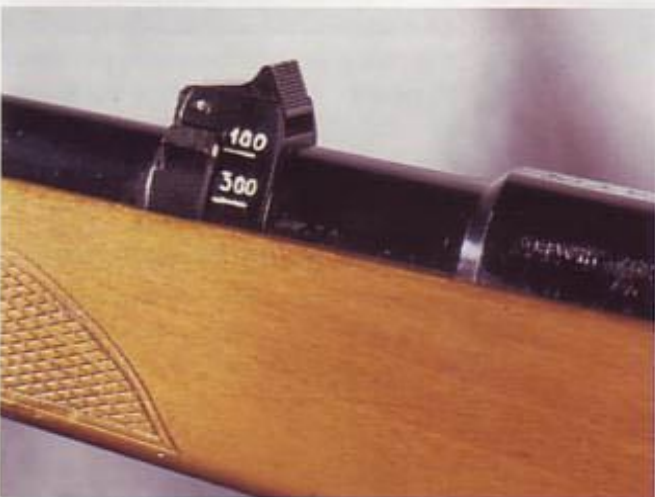
Прицельная колодка с фиксированным положением для стрельбы на 100 м и 300 м
