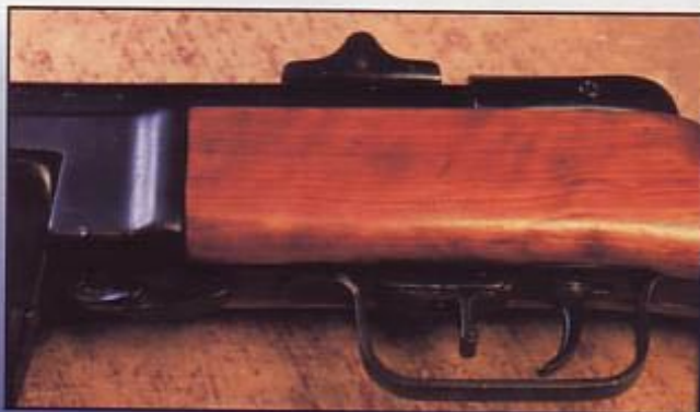
Переводчик огня в положении «одиночный огонь», рычаг защелки магазина поднят
