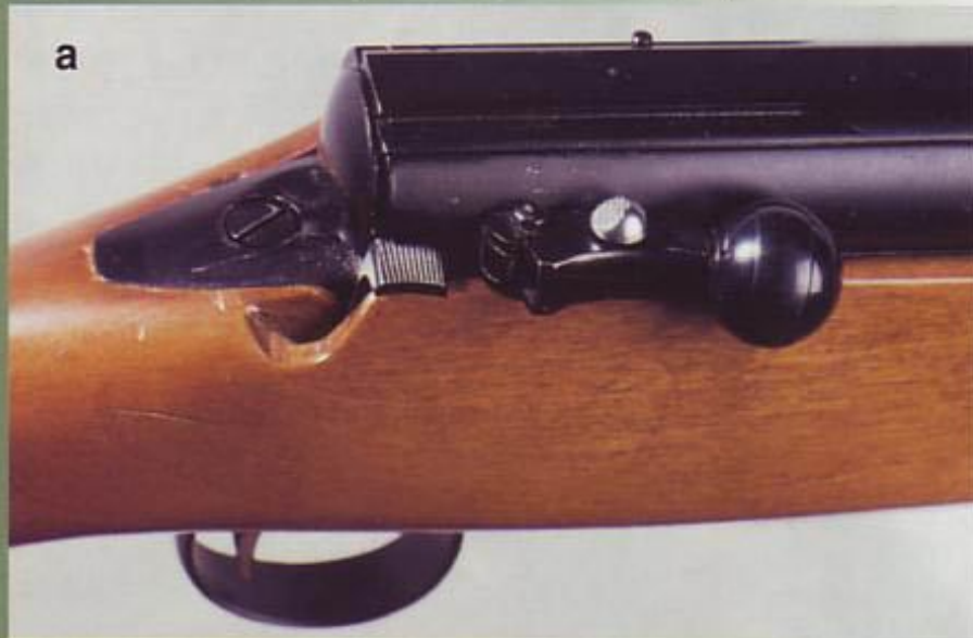
а) рукоятка затвора сложена (походное положение), предохранитель включен
