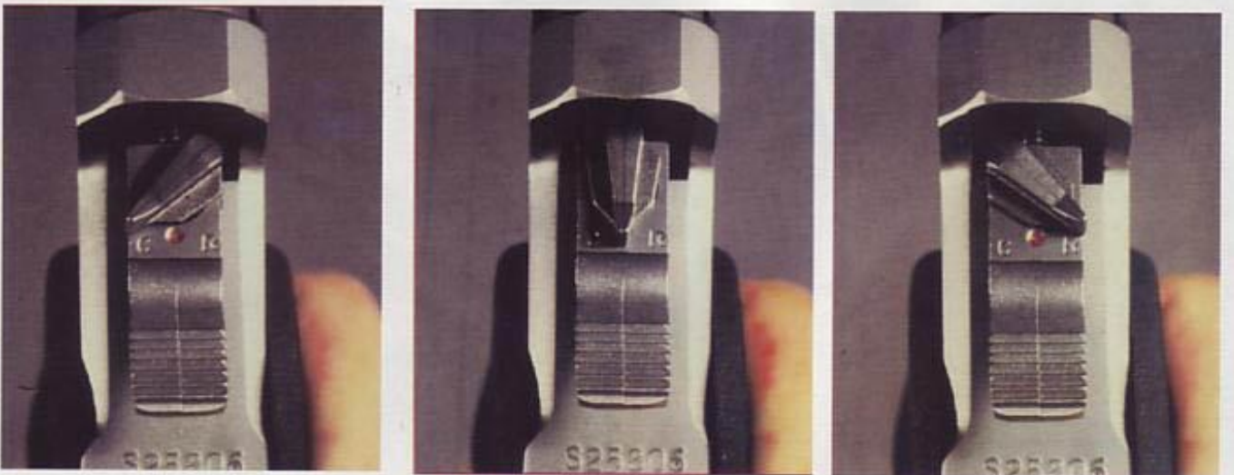
Переключатель режима работы бойков расположен на курке. Левое положение С — для патронов центрального воспламенения. Центральное положение — предохранитель. Правое положение R — для патронов кругового воспламенения
