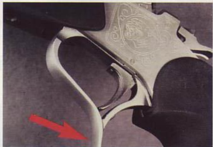
Спусковая скоба, одновременно служит рычагом для откидывания ствола
