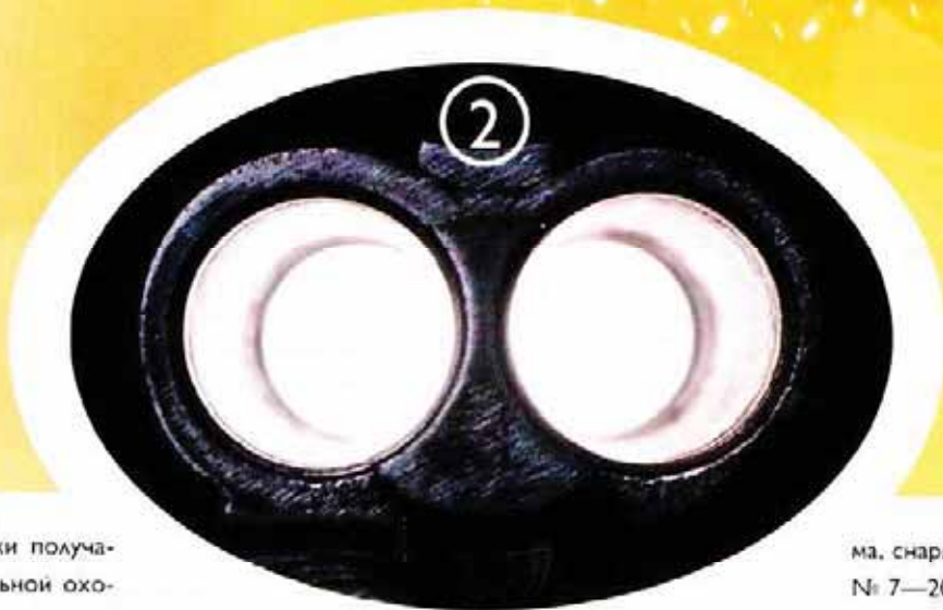
1 Каналы стволов ружей после стрельбы стальной дробью
