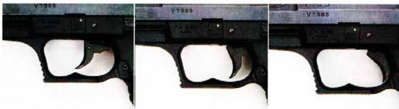
Ход спускового крючка. Среднее положение — предварительный взвод (язычок спускового крючка подтянут к рукоятке пистолета)
