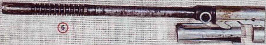
Затвор и затворная рама с газовым поршнем: (а) MP-43, (б) Mkb-42 (H)
