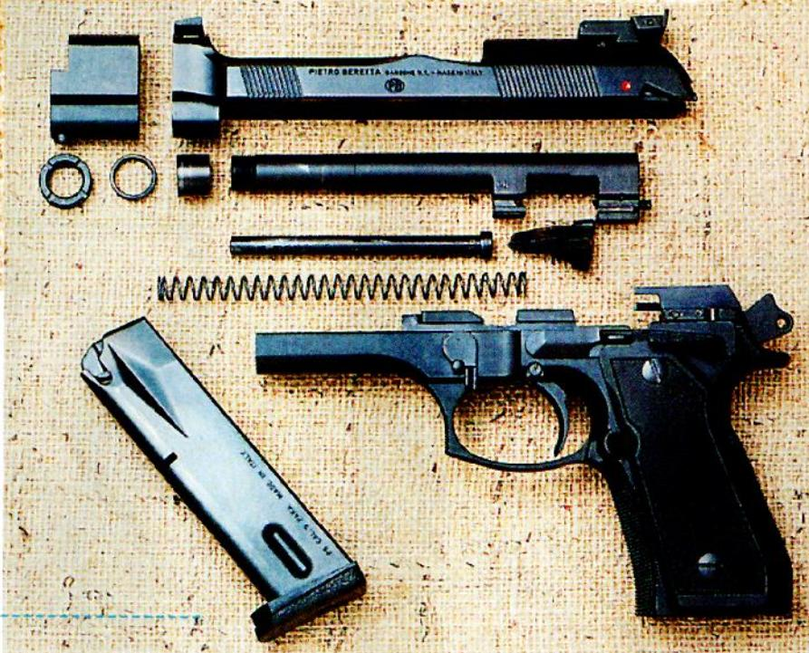
втствует нынешним требованиям: имеет увеличенную кнопку магазина, двусторонний рычаг безопасного спуска курка, предохранитель ударника, регулируемый прицел с микрометрическим винтом и насечку на торцах рукояти. Магазин вместимостью 15 патронов не поражает своими размерами, хотя и выступает из рукояти, что, впрочем, создаёт дополнительную опору для ладони.
