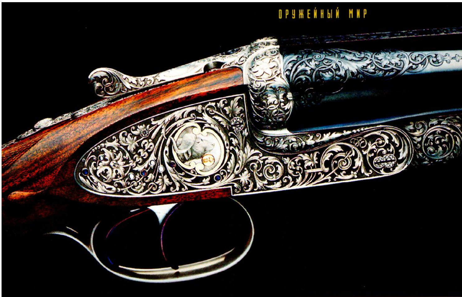
Оружейный гарнитур для сафари. Двуствольный штуцер по патрону 470 N.E. Подкладные залки на боковых досках
