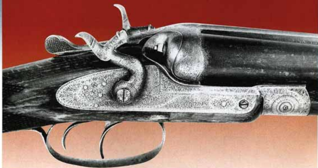
Фрагмент ружья, изготовленного «Льежской мастерской изящного оружия А. Дефурни» в конце прошлого столетия. Коробка взята в дерево до шарнира, замки привинчены прямо к дереву
