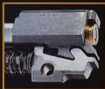
ствол у П-95 нижним фигурным выступом упирается в соответствующий вырез задней части штока возвратной пружины
