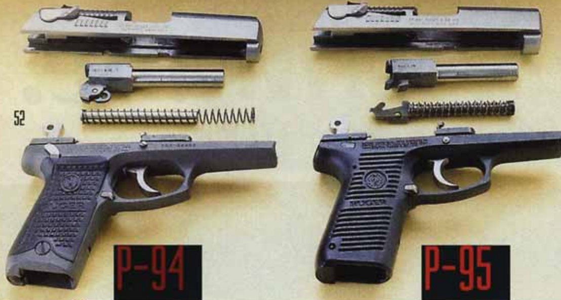
ствол у П-95 нижним фигурным выступом упирается в соответствующий вырез задней части штока возвратной пружины
