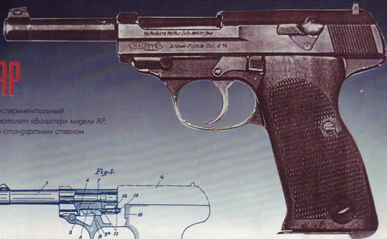
Германский патент DRP 721.702 на систему запирания ствола качающейся защёлкой
