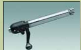
**SR 30.** Продольно-скользящий затвор с шариковым запиранием. Перезаряжание осуществляется посредством передвижения рукоятки затвора в горизонтальной плоскости, т. е. без поворота. Ход затвора лёгкий, а процесс перезаряжания в достаточной степени бесшумен.
