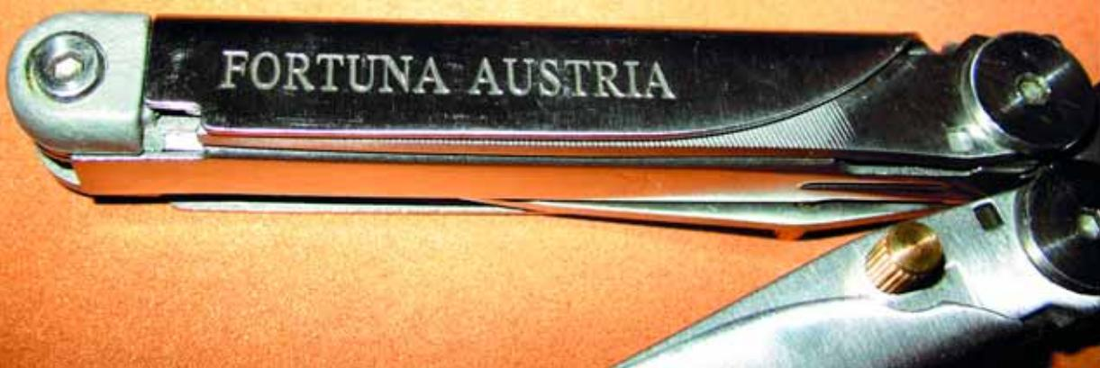
надлежит изначально, кто кого клонировал? Одно «но» - он уже почти развалился. Клинок держится молодцом, и материал его действительно похож на сталь 440, но ручка, лишённая положенных деталей, отдаёт концы и разбалтывается, а слишком тонкий и сырватый фиксатор всё хуже держит клинок.
