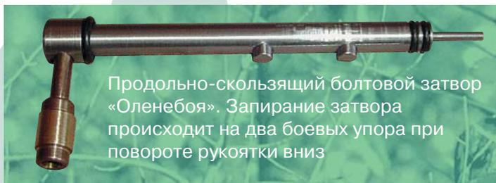
Продольно-скользящий болтовой затвор «Оленебой». Запирание затвора происходит на два боевых упора при повороте рукоятки вниз
