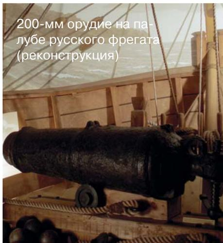
200-мм орудие на палубе русского фрегата (реконструкция)
