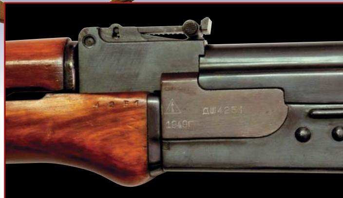
Под производство АК выделили Ижевский машиностроительный завод. Базовая технология завода с царских времён была рассчитана на изготовление основных деталей оружия из поковок с последующей обработкой резанием. Детали из дерева фрезеровали из цельных кусков отборной древесины. Обе технологии очень трудозатратные и материалоёмкие.
