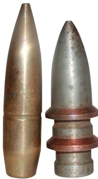
Пуля патрона 14,5x114 (слева) и экспериментальный снаряд калибра 21/16 мм
