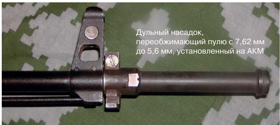
Дульный насадок, переобжимающий пулю с 7,62 мм до 5,6 мм, установленный на АКМ
