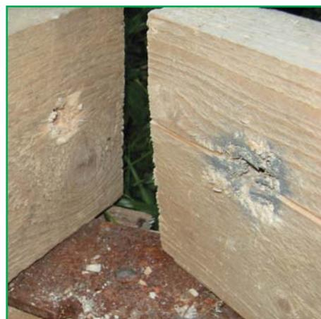
На второй пробитой доске очевидны следы разрушения пули
