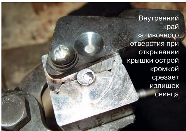
Внутренний край заливочного отверстия при открывании крышки острой кромкой срезаёт излишек свинца
