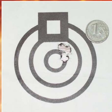
Мишень с результатами фабричного отстрела винтовки H-S Precision патронами ручной сборки
