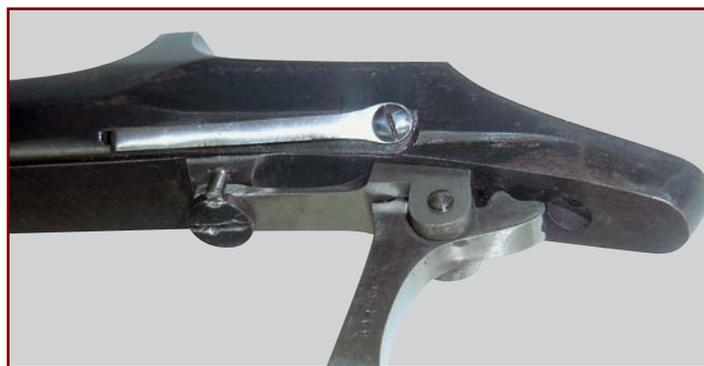
Развитие мосинской идеи отсечки-отражателя - от однозарядной винтовки обр.1890 г. до серийной «пачечной» обр. 1891 г.
