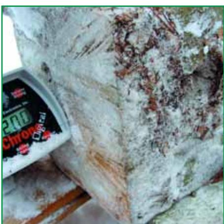
200-мм пенобетон снизил скорость пули до 200 м/с при  $E=160$  Дж
