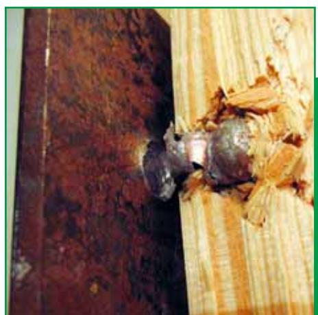
Пробка, выбитая из 7,5-мм стали, способна пробить половину доску
