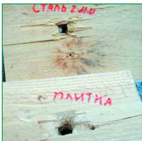
Сравните размеры выходных отверстий в досках после пробития стали и плитки. Для сравнения рядом - выходные отверстия после прострела одних лишь досок
