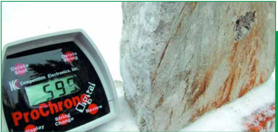
За 80-мм пенобетоном скорость пули составила 599 м/с при  $E=1435$  Дж
