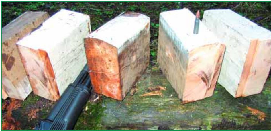
Пуля НР справилась лишь с двумя березовыми брусками по 80мм каждый...
