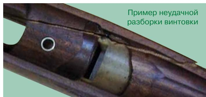
Извлечение ствольного блока из ложи методом «отжима» затвора
