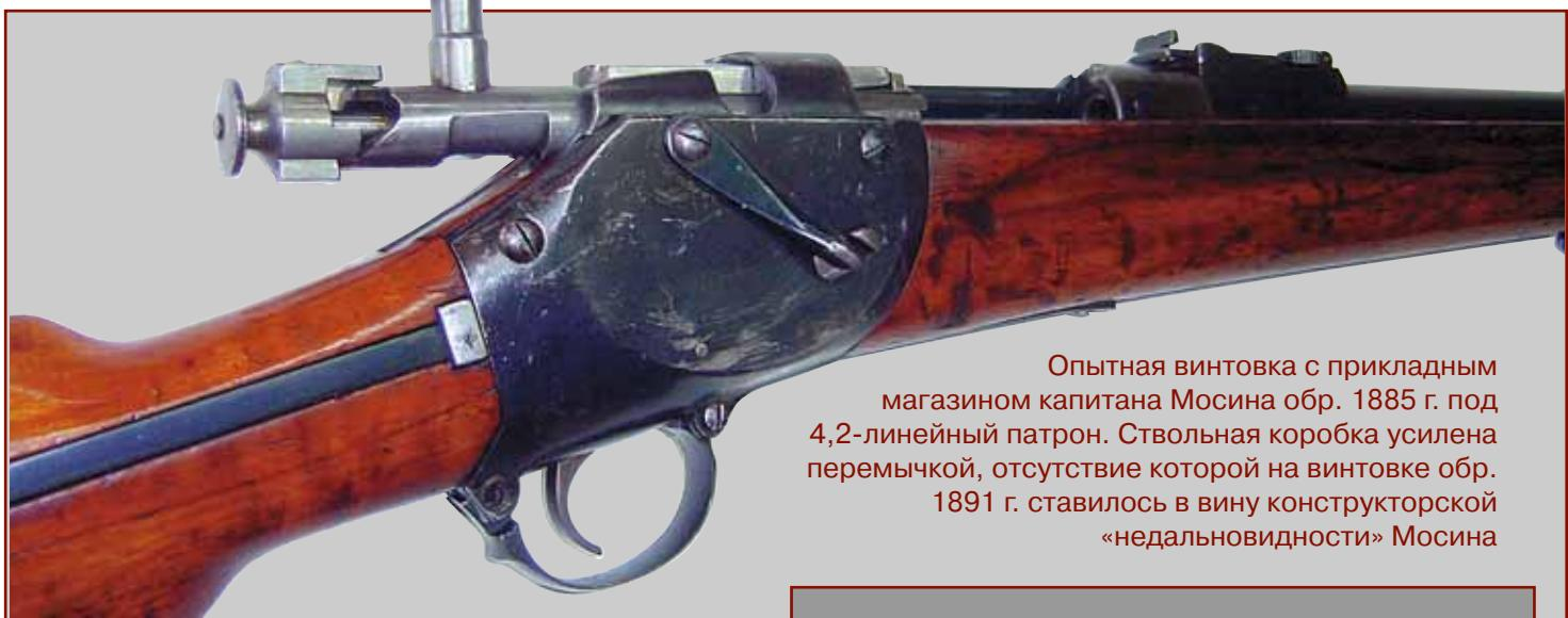
Опытная винтовка с прикладным магазином капитана Мосина обр. 1885 г. под 4,2-линейный патрон. Ствольная коробка усиlena перемычкой, отсутствие которой на винтовке обр. 1891 г. ставилось в вину конструкторской «недальновидности» Мосина
