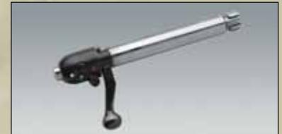
Поворотный затвор, с тремя боевыми упорами. Угол поворота рукоятки затвора всего 54 градуса. В задней части стебля затвора смонтирован рычажок предохранителя, имеющий три положения. В среднем положении блокируется спусковой крючок, тогда как рукоятка затвора может быть перемещена для разряда карабина. Спусковой механизм со шнеллером.
