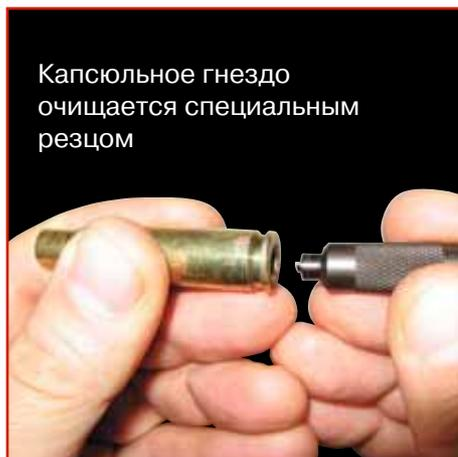
Капсюльное гнездо очищается специальным резцом
