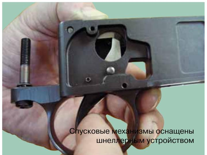
Спусковые механизмы оснащены шнеллерным устройством
