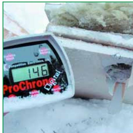
Картечь 7,5 мм. Скорость снаряда после пробития «евростены» - 146 м/с
