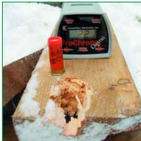
Картечь 7,5 мм. Скорость снаряда после пробития 50-мм доски - 221 м/с
