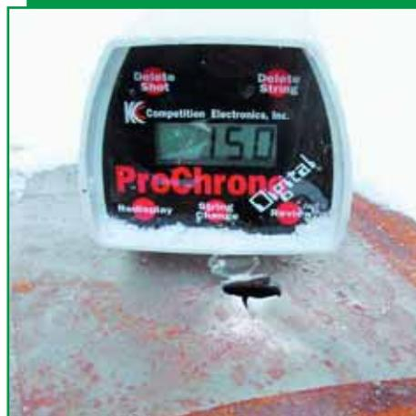
Пуля «Стрела». Скорость после пробития комбинированного препятствия из 2-мм стали и 50-мм доски - 165 м/с
