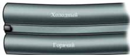
**Илл . 2.** При выстреле ствол штуцера сильно нагревается и, удлиняясь, изгибает спаянный с ним холодный ствол
