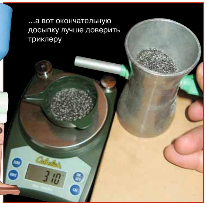
воляют средства, можно приобрести более сложный агрегат, наподобие RCBS Powdermaster. Он самостоятельно отмеривает и отвешивает необходимые навески. Если порох взвешивать вручную, придётся смириться с тем, что эта процедура - одна из наиболее трудоёмких и кропотливых.
