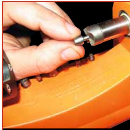
...устанавливаем в триммер пилот нужного калибра...
