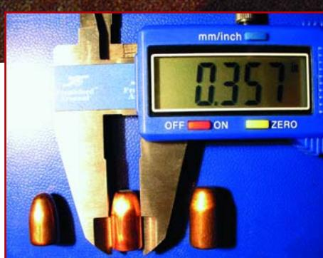
Калибр пули должен соответствовать калибру ствола. Ведь избежать путаницы не так уж и просто: в пистолетных патронах .380 ACP и 9 мм Para используются пули калибра .355 (9,02 мм), а в патронах .38 Sp и .357 Mag - пули калибра .357 (9,07 мм)
