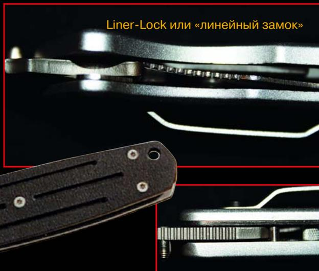
Liner-Lock или «линейный замок»
