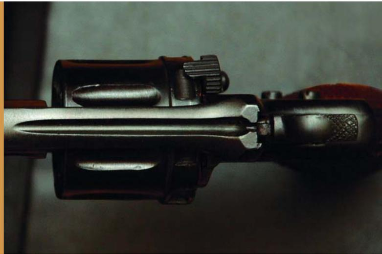
**ПЕРЕЗАРЯЖАТЬ НАГАН НУЖНО ОЧЕНЬ МЕДЛЕННО. ДЛЯ ЭТОГО НАДО КАЖДЫЙ РАЗ ПРИВОДИТЬ ЭКСТРАКТОР В РАБОЧЕЕ ПОЛОЖЕНИЕ НЕСКОЛЬКИМИ МАНИПУЛЯЦИЯМИ. ЗАТЕМ, ВРАЩАЯ БАРАБАН, ПООЧЕРЁДНО УДАЛЯТЬ СТРЕЛЯНЫЕ ГИЛЬЗЫ ЧЕРЕЗ ОТКИНУТУЮ БАРАБАННУЮ ДВЕРЦУ И ТАК ЖЕ ПООЧЕРЁДНО ЗАРЯЖАТЬ КАМОРЫ НОВЫМИ ПАТРОНАМИ. ВСЁ ЭТО ДЕЛАЛО НАГАН ОБРАЗЦА 1895 ГОДА НЕСОВЕРШЕННЫМ ДАЖЕ ДЛЯ СВОЕГО ВРЕМЕНИ**
